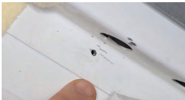
Рис. 4. Отверстие, обнаруженное в бытовом отсеке ТПК «Союз МС-09»
