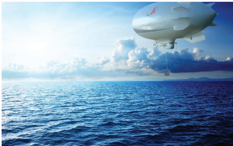
Рис. 6. Эвакуация спускаемого аппарата на внешней подвеске
