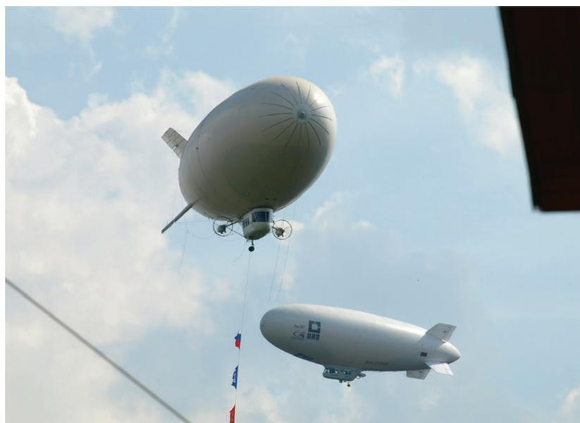
Рис. 2. Дирижабли AU-30, выполнявшие дистанционный аэромониторинг высоковольтных линий электропередачи в РФ в 2007–2009 гг.
