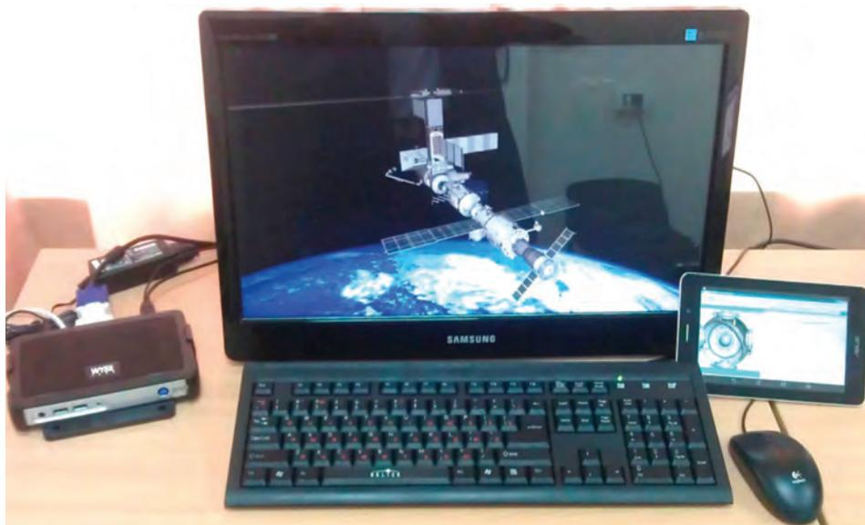
Рис. 1. Пример унифицированного рабочего места на основе тонкого клиента системы виртуализации и беспроводного клиента на Android планшете (прототип на базе ООО «Центр тренажеростроения и подготовки персонала»)
