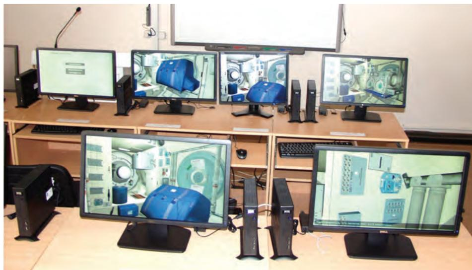
Рис. 5. Действующий прототип ФМС на основе применения технологий виртуализации, тонких клиентов и набора графических и вычислительных серверов (тестовый стенд на базе ООО «Центр тренажеростроения и подготовки персонала»)
