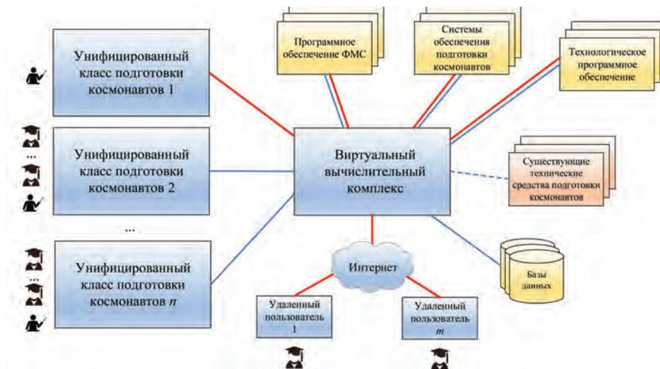
Рис. 2. Укрупненная структура комплекса дистанционного проведения подготовки космонавтов
