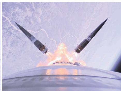
Рис. 8. Пуск РН «Союз-2.1а» с КА «Канопус-В» № 3 и № 4 01.02.2018, космодром Восточный, отделение I ступени
