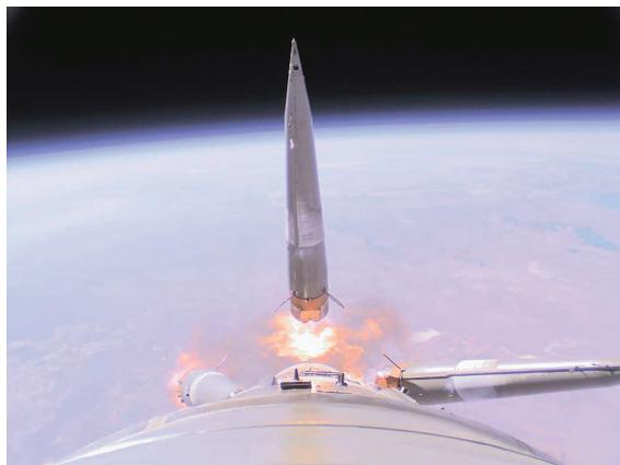
Рис. 12. Пуск РН «Союз-ФГ» с ТПК «Союз МС-10» 11.10.2018, космодром Байконур, нештатное отделение I ступени
