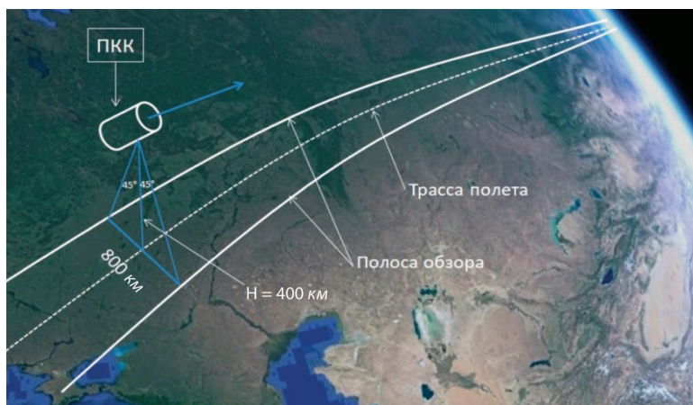
Рис. 2. Полоса обзора поверхности Земли с орбиты 400 \text{ км}
