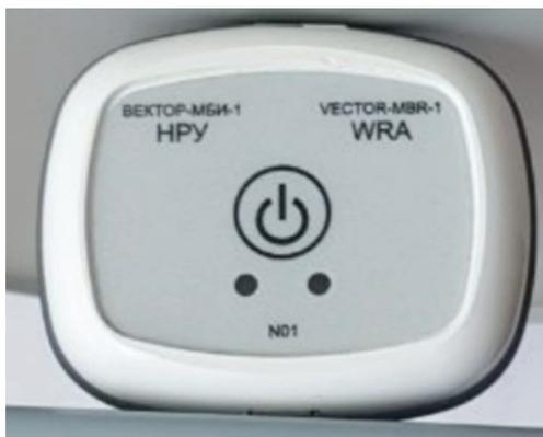
Рис. 1. Носимый регистратор ускорений ВЕКТОР-МБИ-1
