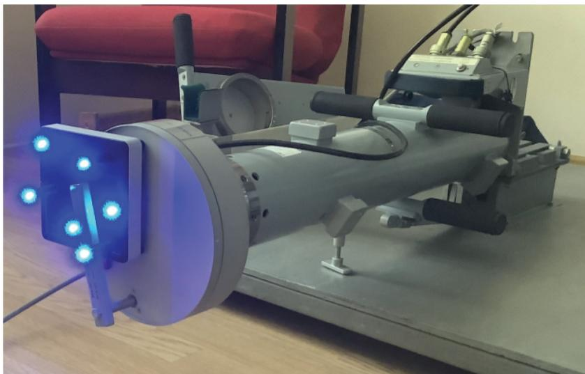
Рис. 3. Измеритель масс с закрепленным ИРУ
