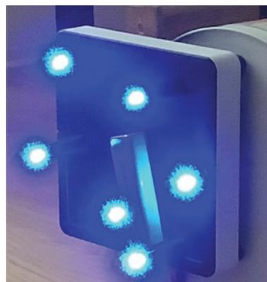
Рис. 2. Корпус для регистратора ускорений
