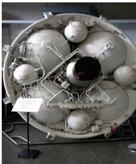
Рис. 5. Комбинированная двигательная установка корабля «Союз-Т»
