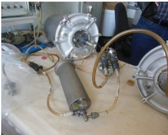
Рис. 7. Сепаратор на основе мембранного фильтра-разделителя
