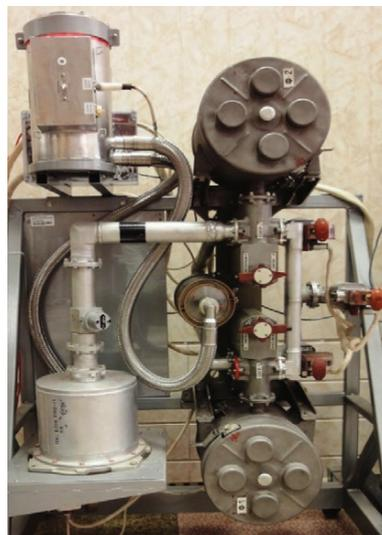
Рис. 12. Стенд-тренажер очистки атмосферы от микропримесей – БМП
