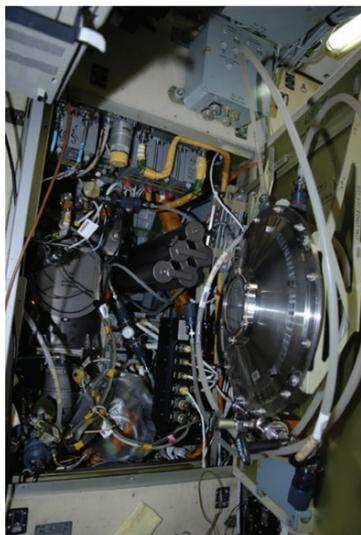
Рис. 6. Газожидкостный сепаратор ГЖС
