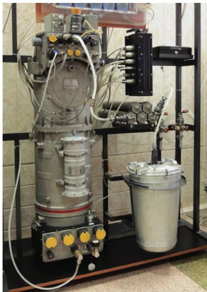
Рис. 5. Система кислородообеспечения «Электрон-ВМ» МКС
