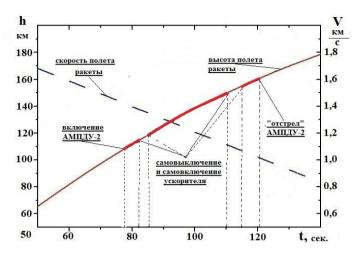
Рис. 22. Области существования плазменной струи АМПДУ-2, работающего на частоте  $f \approx 0.4 \ \kappa \Gamma \mu$
