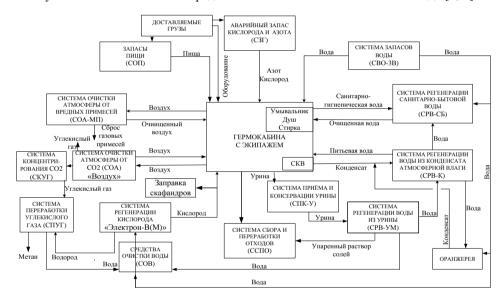
Рис. 1. Комплекс регенерационных систем жизнеобеспечения (РСЖО) космической станции
