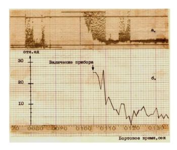
Рис. 23. Результаты измерений параметров плазмы АМПДУ-2: а — запись результатов измерений суммарной концентрации ионов с помощью ионного зонда; б — результаты измерения потока мягких электронов с  $E = 0.5 \ \kappa 9B$ , спектроанализатором СК2 при инжекции плазмы
