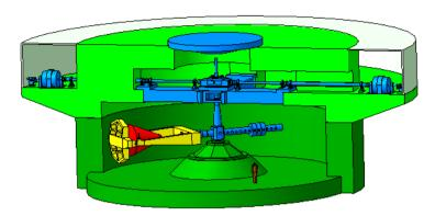
Рис. 3. Схема центрифуги СУ-268
