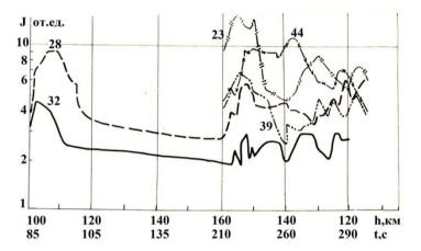
Рис. 16. Состав нейтральных и заряженных частиц около ракет
