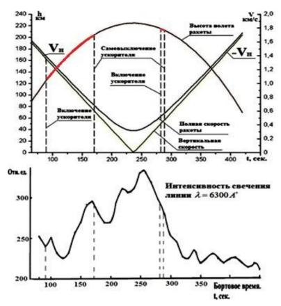
Рис. 20. Параметры, характеризующие полет ракеты и плазменное образование, созданное АМПДУ-1
