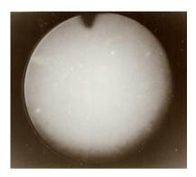
Рис. 24. Телевизионное изображение свечения искусственного плазменного образования, созданного ускорителем плазмы
