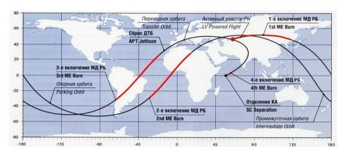
Рис. 29. Стандартная трасса полета КА с двигателями РН «Протон-М», РБ «Бриз-М»
