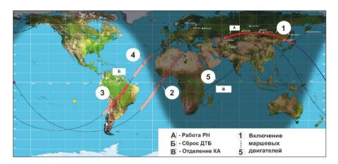
Рис. 30. Реализованная трасса полета КА «Ямал-402»
