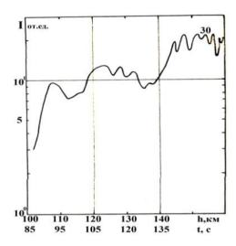
Рис. 15. Изменение ионного состава ионосферной плазмы от высоты
