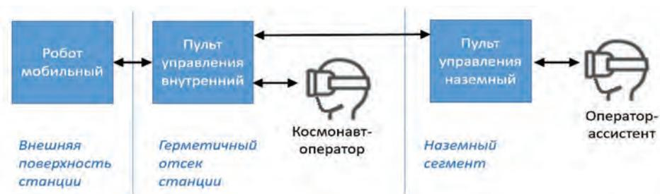
Рис. 2. Система управления роботом космического назначения (проект ЦНИИ РТК)
