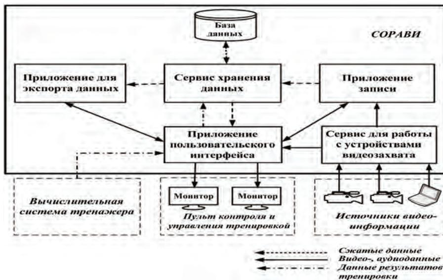
Рис. 3. Архитектура программного обеспечения СОРАВИ
