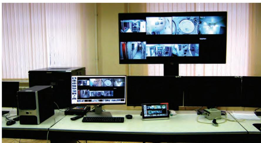
Рис. 2. Внешний вид рабочего места оператора СООВИ, установленной в ЦПК для комплекса тренажеров РС МКС
