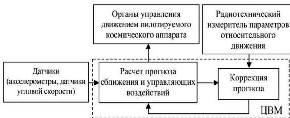
Рис. 1. Упрощенная схема автоматического контура управления в режиме сближения
