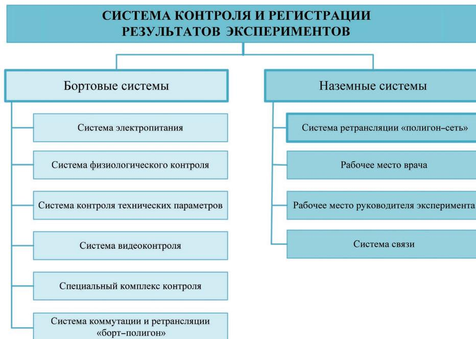
Рис. 3. Состав системы контроля и регистрации результатов экспериментов
