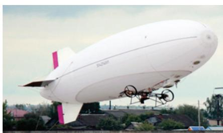
Рис. 7. БЛА аэростатного типа
