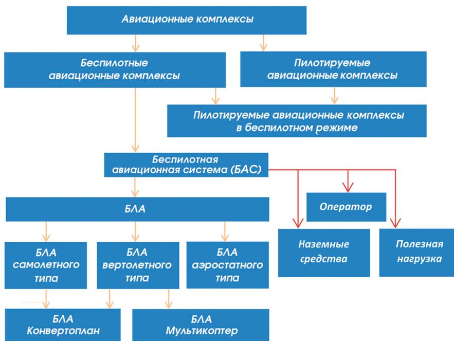
Рис. 4. Обобщенная классификация авиационных комплексов для ПСО экипажей ПТК с возможным применением БЛА
