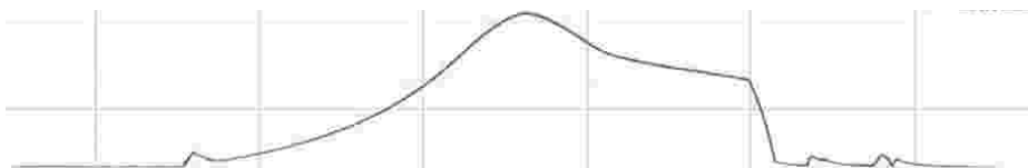
Рис. 11. Задающий график циклограммы вращения УНУ «ЦФ-18»
