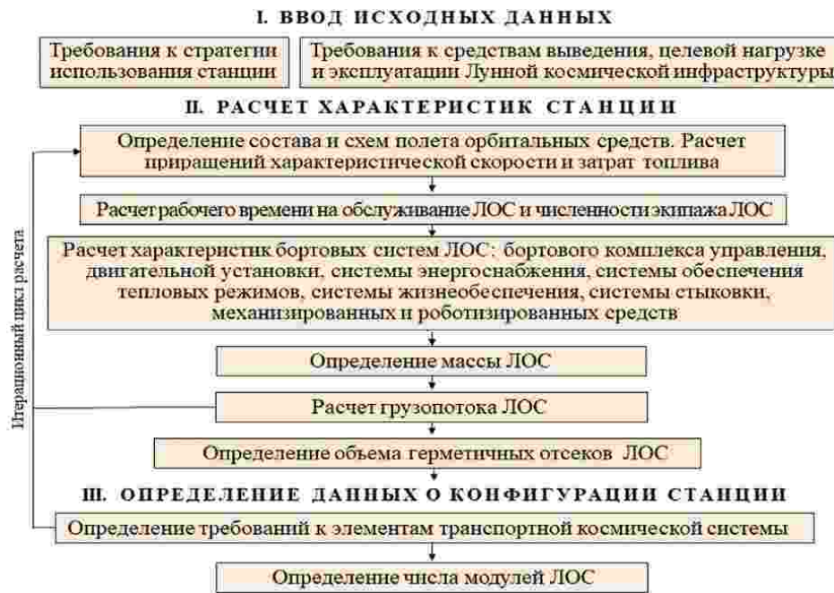
Рис. 2. Структура расчетной математической модели ЛОС
