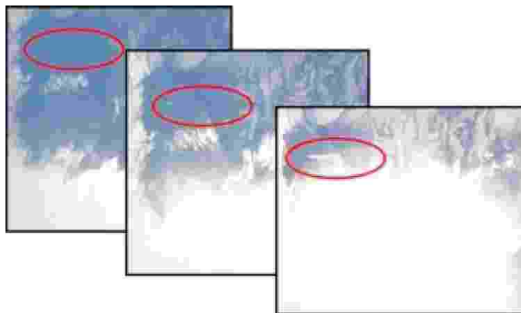
Рис. 14. Снимок следа судна в условиях солнечного блика на морской поверхности. Волнение 0–1 балл, диаметр блика на морской поверхности – около 300 км
