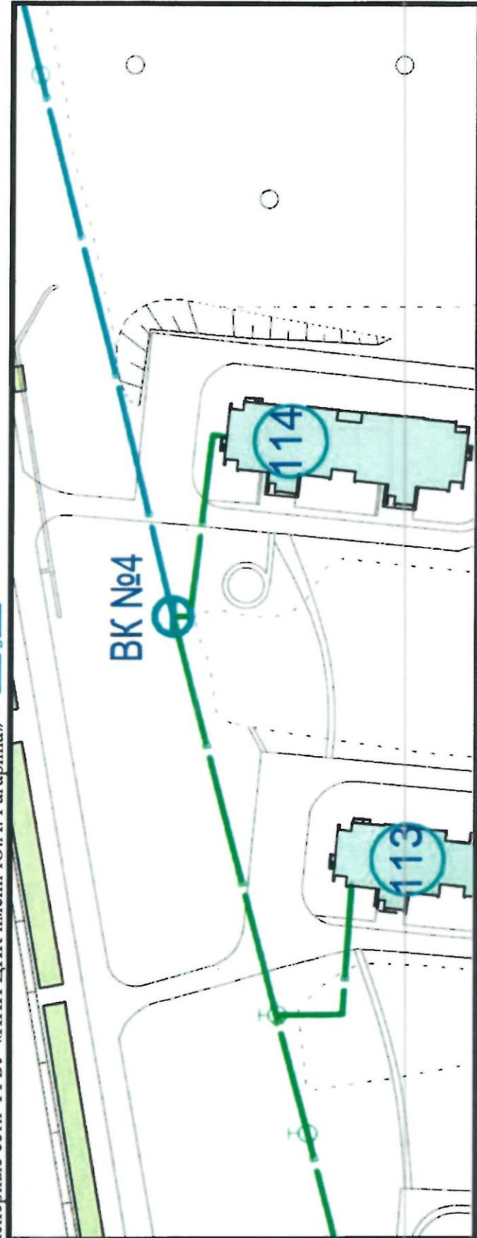
ПРИМЕЧАНИЕ: границы балансовой принадлежности и эксплуатационной ответственности сетей водоснабжения проходит по последнему фланцу запорной арматуры относительно потока подачи воды
