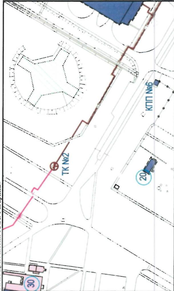
ПРИМЕЧАНИЕ: границы балансовой принадлежности и эксплуатационной ответственности сетей отопления проходят по последнему фланцу запорной арматуры относительно потока подачи теплоносителя.
