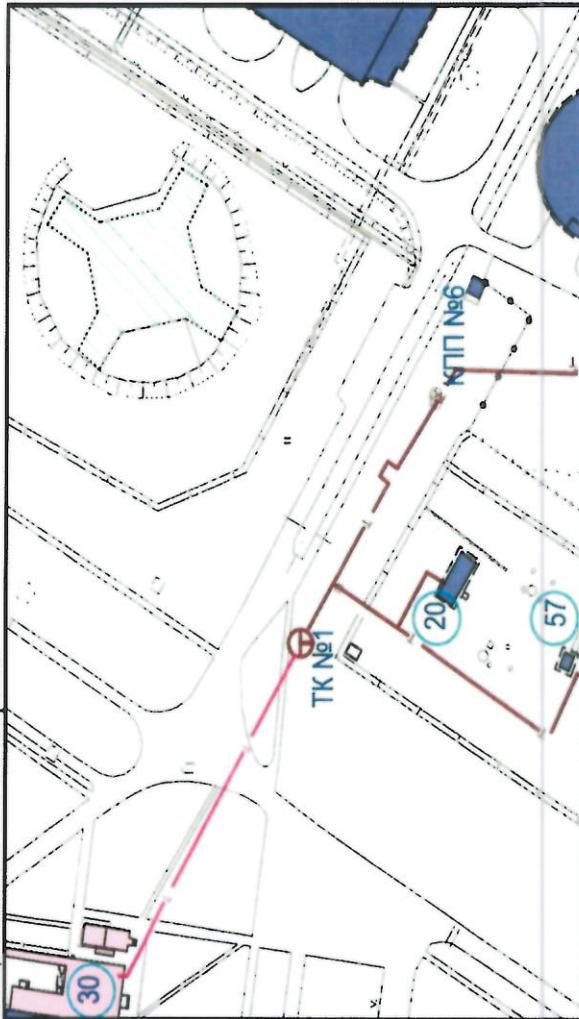
ПРИМЕЧАНИЕ: границы балансовой принадлежности и эксплуатационной ответственности сетей отопления проходят по последнему фланцу запорной арматуры относительно потока отопления по последнему фланцу запорной арматуры отопления.
